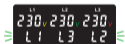
Рисунок 7. Внешний вид дисплея лицевой панели реле в случае неправильного порядка чередования фаз
