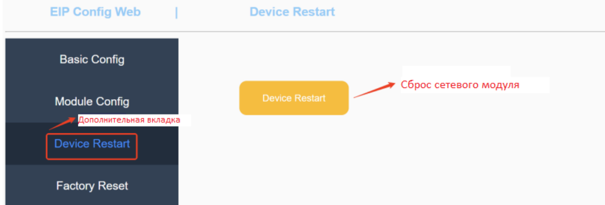
Рисунок 87 – Перегрузка станции удалённого ввода и вывода
