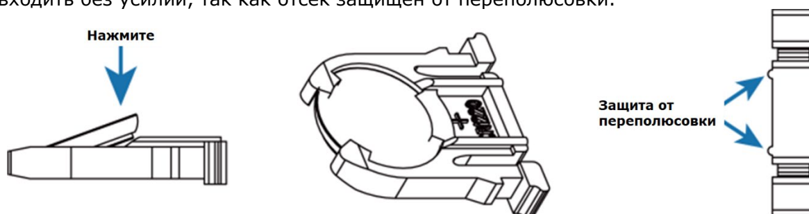
Рисунок 38 – Установка в батарейный отсек RTC новой батарейки
