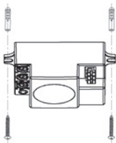
Рис. 8 - Монтаж датчика MW-706
